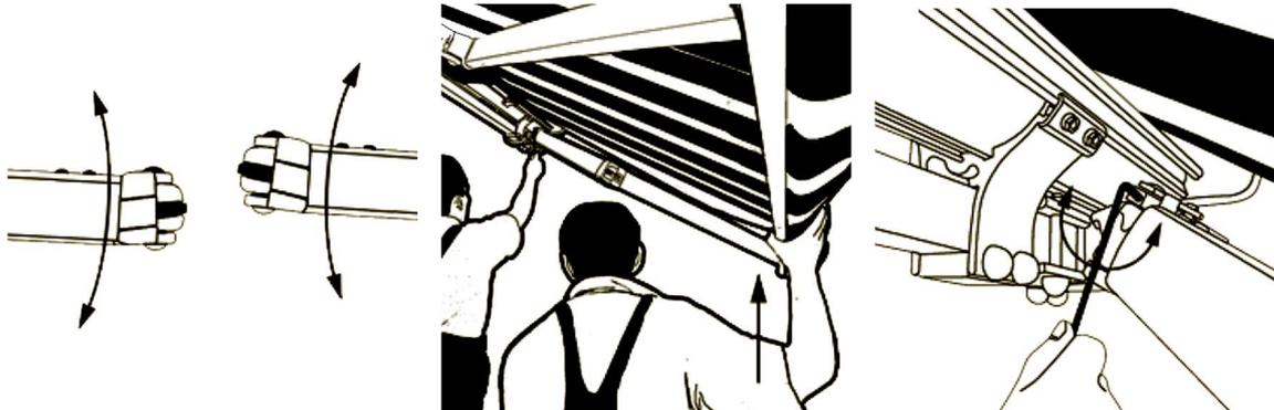
14) Prüfen sie mit Hilfe der Wasserwaage, ob die Gelenkarme in einer Ebene zueinander schließen.
