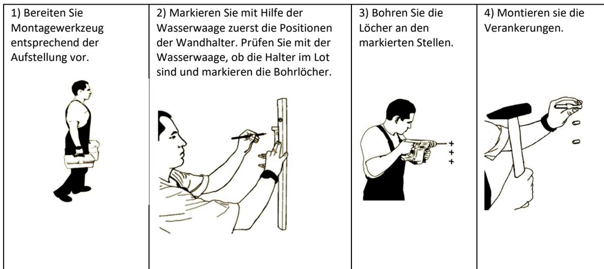
5) Die Montage der Wandhalter ist nur in den Varianten wie in den Zeichnungen unten dargestellt, zulässig: Verwendung aller 3 Löcher (ausschließlich bei Betonuntergrund), des oberen und des unteren Lochs (Verankerungen Thermax). Bitte beachten sie die Vorgaben des Herstellers der verwendeten Verankerungen bzgl. der Abstände, der Vorbereitung und der Montage der Verankerungen.
