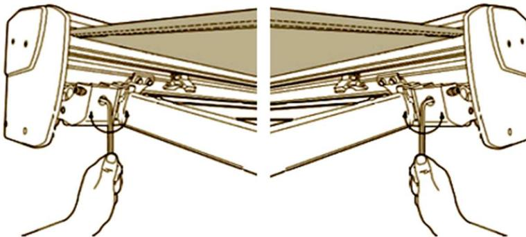
19) Prüfen Sie mit Hilfe der Wasserwaage, ob das Fallprofil sich im Lot befindet.
