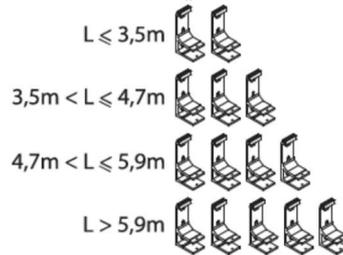
Die beiden äußeren Halter sollten in einem Abstand zw. 20 cm bis 45 cm von der Markisenaußenkante angebracht werden. Die restlichen Halter müssen proportional zueinander in den gleichen Abständen von der Markisenaußenkante angebracht werden.
