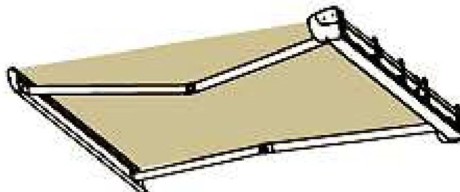
13) Sollte eine Einstellung notwendig sein, nehmen Sie diese durch Herein-/Herausdrehen der unten abgeb. Schraube in den Gelenkarmen vor. Sollten Sie Einstellungen an den Gelenkarmen oder dem Neigungswinkel vornehmen, muss eine Person die Gelenkarme durch leichtes Nach-Oben Drücken entlasten.
