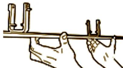
16) Bringen Sie das Verblendungsprofil mit Haltern am quadratischen Profil 40x40 mit Hilfe der Schrauben M8x70 an.
