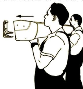
11) Sichern Sie das quadratische Markisenprofil mit Hilfe der Schraube M8x65 und montieren anschließend die Kunststoffabdeckung.
