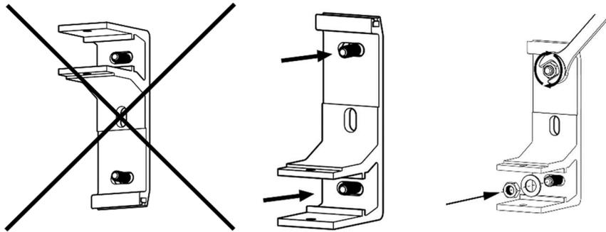
6) Analog zum ersten Halter (Basis) bestimmen Sie die Position der restlichen Wandhalter und montieren diese. Achten sie besonders darauf, dass alle Halter in einer Ebene und auf einer ebenen Wandfläche montiert werden.
